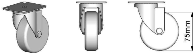
<그림 4-4> Dimensions of Rear Caster
